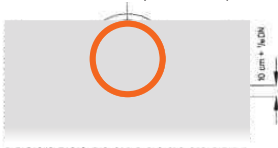
Рис. 6 Укладка в ненарушенный грунт естественного залегания (тип основы 1)
